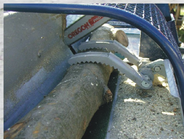
Les bras de tenue serrent le tronc de sorte à l'empêcher de tourner ou de culbuter, ce qui assure la chute correcte du dernier morceau dans le bac des pièces à fendre.
