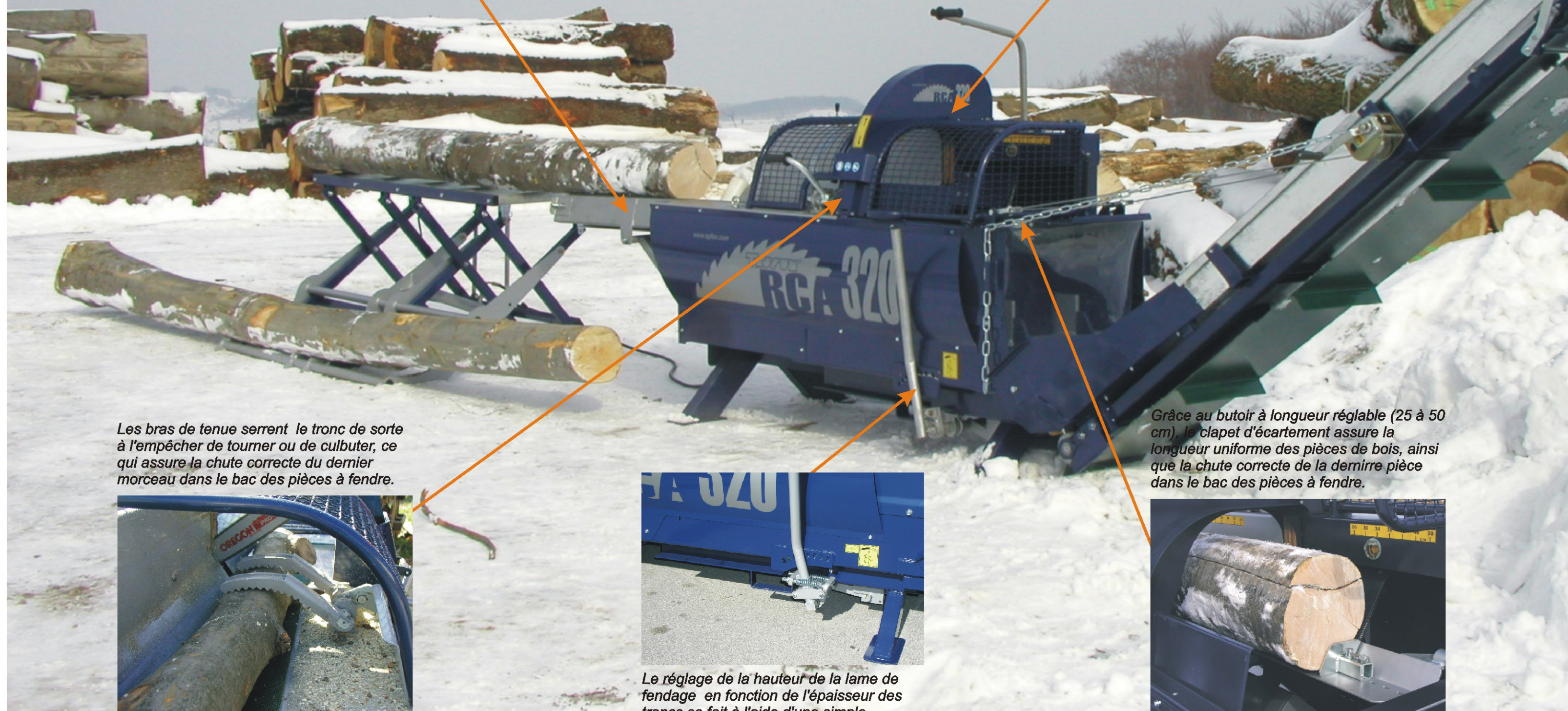
Le tapis d'amenée pliable (2 m) assure l'acheminement aisé des troncs longs et lourds.
