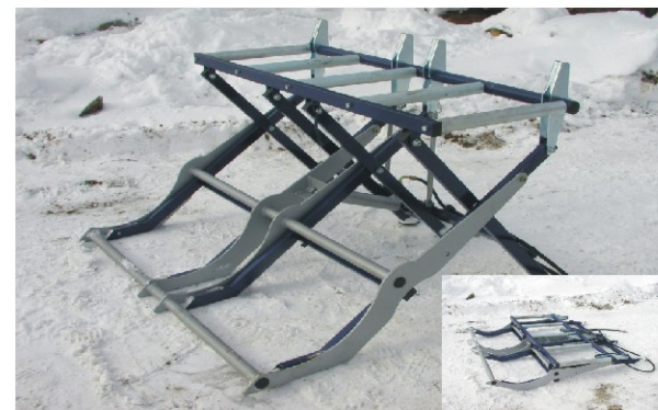
La table élévatrice hydraulique (option) élève les troncs à la hauteur de travail. Elle peut également servir de petite surface de stockage de troncs pour faciliter le travail.
