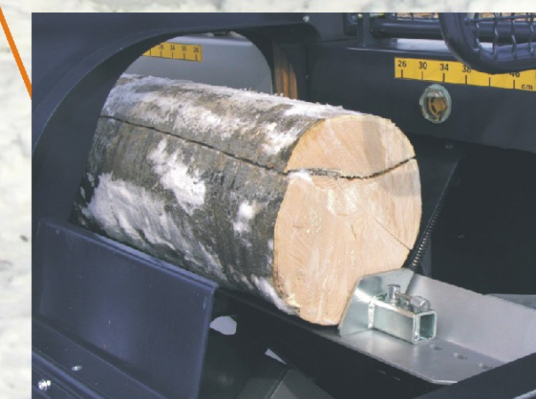
Grâce au butoir à longueur réglable (25 à 50 cm), le clapet d'écartement assure la longueur uniforme des pièces de bois, ainsi que la chute correcte de la dernière pièce dans le bac des pièces à fendre.
