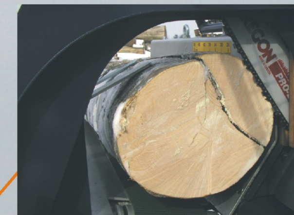
La scie à chaîne assure un sciage sûr et rapide, de plus, l'entretien est aisé..
