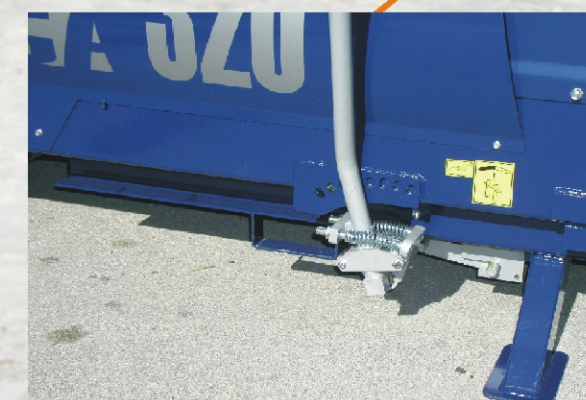
Le réglage de la hauteur de la lame de fendage en fonction de l'épaisseur des troncs se fait à l'aide d'une simple manette.
