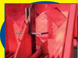
Lames de fendage avec renfort démontable
