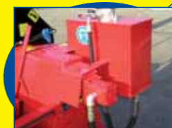
Détail du réservoir et de la pompe hydraulique
