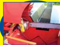
Guide et chaîne entraînée par moteur hydraulique
