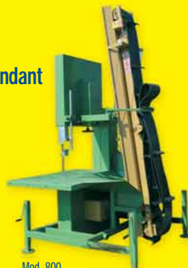
Mod. 800 avec tapis incorporé - longueur 5 mètres position transport
